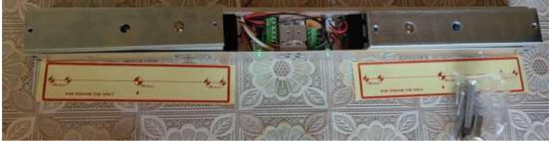
备注：通电吸合，带反馈，注意指示灯颜色变化。
