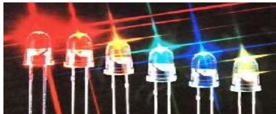
实际电路应用中发光二极管主要有三种颜色，然而三种发光二极管的压降都不相同，具体压降参考值如下：
