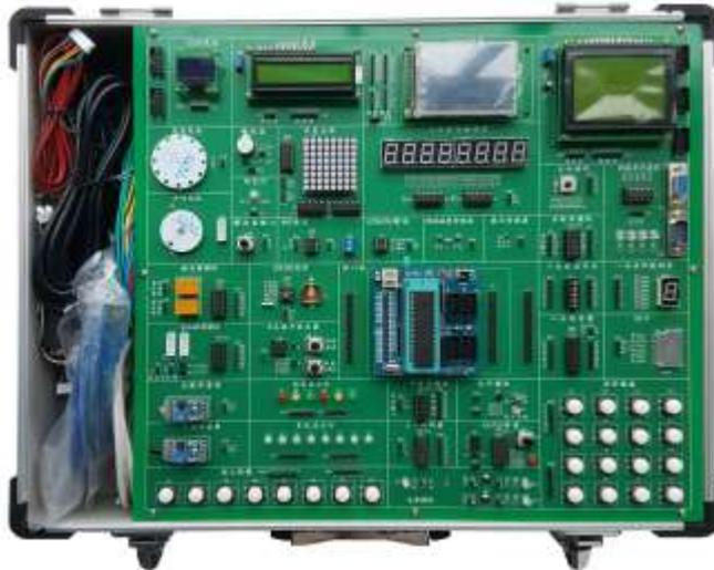
单片机核心板既可直接插到功能底板组合为多功能实验箱, 也可以作为一个最小系统核心板单独使用, 灵活度高、扩展性极强。
