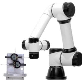
机器人重复定位测试
