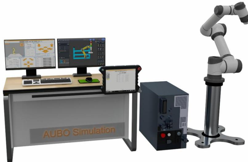
机器人数字孪生仿真基础工作站
