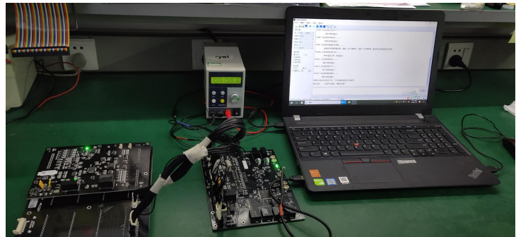
电路检测程序烧写
