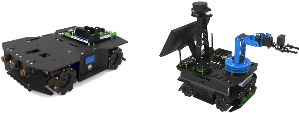
特点：移动 AGV 平台+桌面式机械臂构成全功能版本，AI 模块通过磁力吸合方式在桌面式实训操作台与移动 AGV 平台上灵活部署使用，编程开发与动手实践的完美结合，搭载 6 轴机械臂与末端夹爪，可灵活实现更多创意应用。
